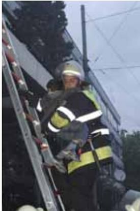
„Tragbare Leitern“ der Feuerwehr sind Leitern, die von einem oder mehreren Leuten vom Fahrzeug zum Einsatzort getragen werden können. Dadurch sind sie sehr flexibel zur Menschenrettung oder Brandbekämpfung, sowie für technische Hilfeleistungen einsetzbar. Im Winter kann damit ebenso eine provisorische Eisrettung durchgeführt werden.
