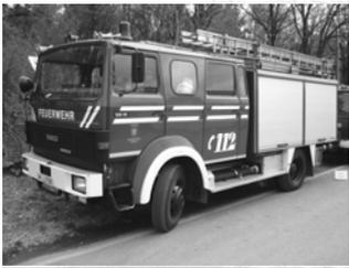
Das LF 16/12 der alten Bauart ist ein Löschgruppenfahrzeug mit einem 1200 Liter Wassertank. Es verfügt über Atemschutzgeräte, die im Mannschaftsraum untergebracht sind. So kann sich der Angriffstrupp bereits während der Anfahrt ausrüsten.
