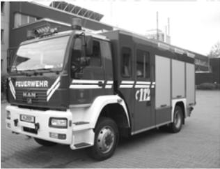
Das LF 16/12 der neuen Generation ist das Erstfahrzeug der Abteilung. Es besitzt neben der feuerwehrtechnischen Beladung, wie z.B. ein im Schnellangriff integriertes Schaummittelsystem auch diverse Rettungsgeräte zur technischen Hilfeleistung.
